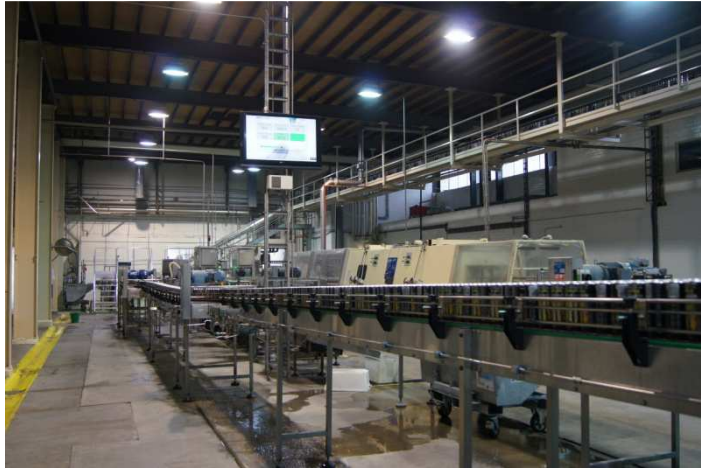
Figuur 19: Boven elke productielijn hangt een digitaal scherm met actuele OEE-informatie
